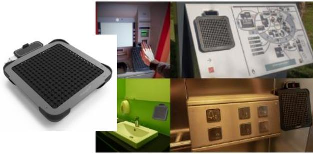
El dispositivo HaptiRead contiene un total de 256 transductores de ultrasonido dispuestos en una cuadrícula de 16 x 16 en su cara frontal. Se utiliza un sensor de gestos *Leap Motion Controller* para detectar cuando un usuario mueve la mano frente al dispositivo. Luego, los transductores de ultrasonido se activan en los patrones y secuencias correctos para producir la escritura.
